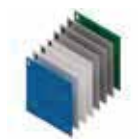
Laminacija filtera po DIN 18820 standardu. Hemijska zaštita izrađena od kombinacije odgovarajućih smola, C-stakla i staklenih vlakana. Mehaničko ojačanje izrađeno metodama radialnog i unakrsnog namotavanja staklenih vlakana. Spoljni zaštitni sloj u boji RAL 5015. Druga boja proizvoda uz 5% doplate.
